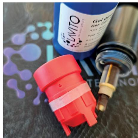
**Visser le bec** verseur sur le tube de #GELPRO (électrolyte) puis l'insérer dans la membrane.
