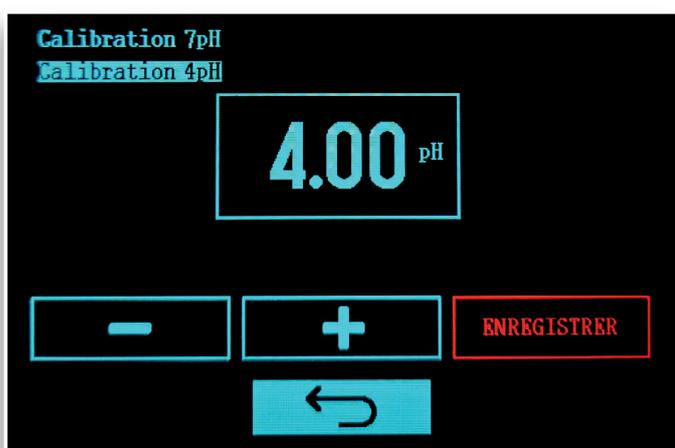
Sortir la sonde pH de la solution pH7, bien l'égoutter et verser quelques gouttes de pH 4 sur la pointe de la sonde puis l'insérer dans la solution pH4.
