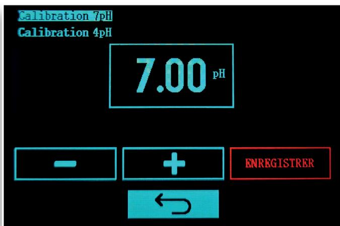
Sortir la sonde pH du porte sondes, bien l'égoutter, verser quelques gouttes de pH 7 sur la pointe de la sonde puis l'insérer dans la solution pH 7.
