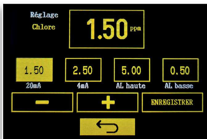
**Alarme haute:** Valeur au dessus de laquelle le Régulateur PROTOUCH va se mettre en alarme.
