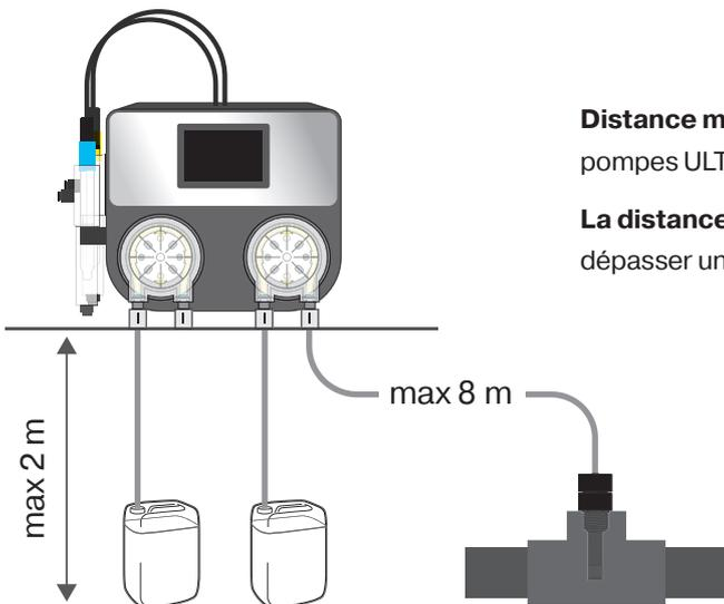
**Distance maximale des cannes d'injection** des pompes péristaltiques Les pompes ULTIMAQUA ne doivent pas dépasser **8m**.
