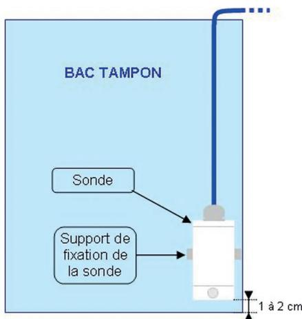
La sonde de niveau est un organe primordial pour le bon fonctionnement de la régulation. Elle doit être positionnée, dans le bac tampon, à 1 cm de la partie la plus profonde du bac (voir schéma ci-contre). Utiliser le support fourni pour la fixation, le placer entre 5 et 6 cm du fond et positionner la sonde. Le câble de la sonde (3 m) doit être protégé par une gaine IRO 9 mm ou similaire jusqu'à la boîte de liaison située à l'extérieur du bac tampon.
