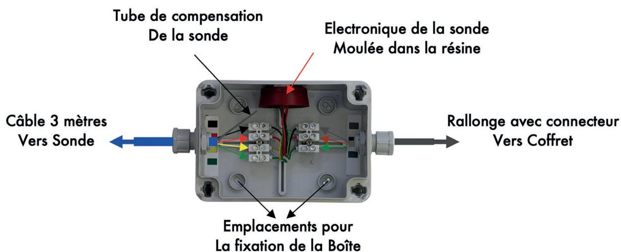
Raccorder la boîte de liaison selon le schéma ci-dessus en prenant soin de ne pas plier le « tuyau de compensation » de la sonde, cela pourrait engendrer un dysfonctionnement.
